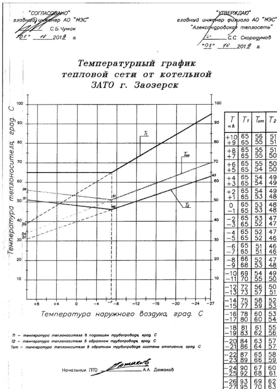
Рисунок 3 – Утвержденный температурный график тепловой сети от котельной ЗАТО г. Заозерск
