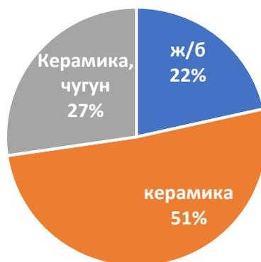
**Рисунок 7 - Структура канализационных сетей в зависимости от материалов труб**
