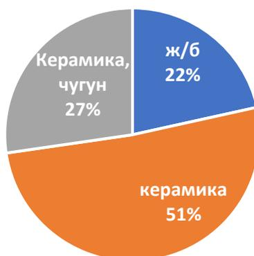
**Рисунок 16 - Структура канализационных сетей в зависимости от материалов труб**
