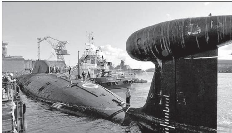
имеет полуторный архитектурно-конструктивный тип - на большей части его длины располагаются однокорпусные участки.
